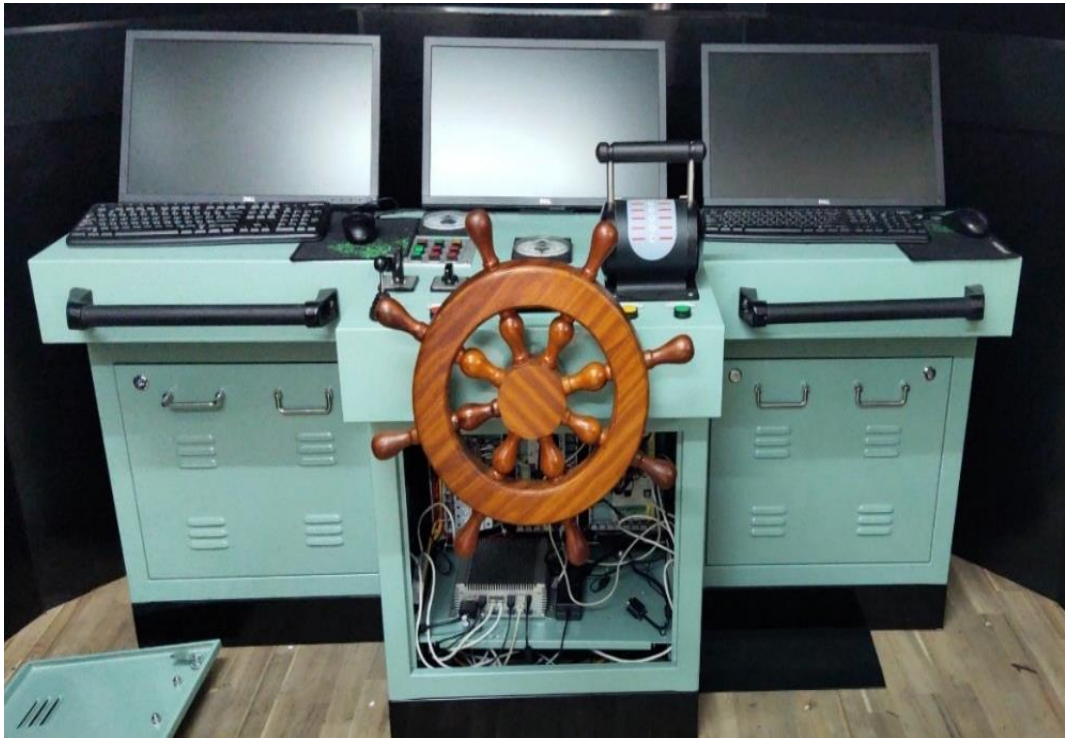
Hình 3.25. Hình ảnh bàn control console buồng lái sau khi được chế tạo
