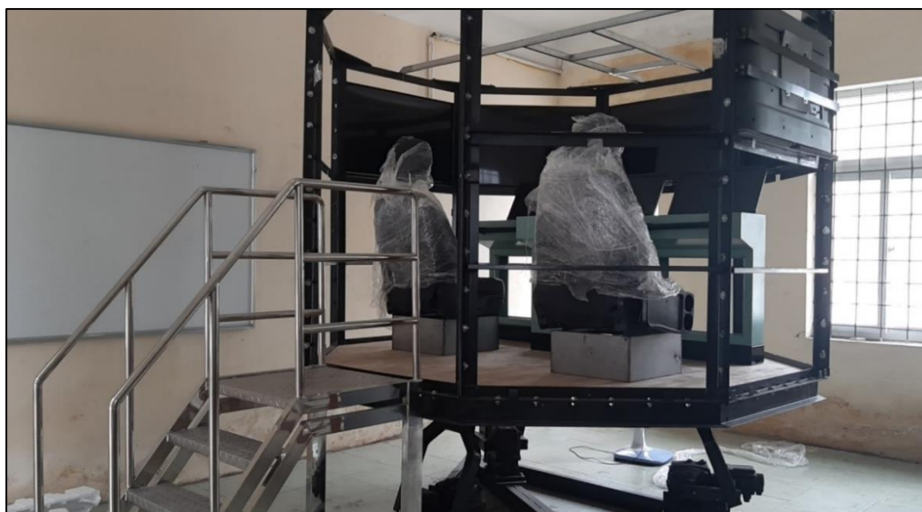
Hình 2.13. Cấu trúc khung cơ khí của hệ thống mô phỏng chuyển động của tàu thủy
