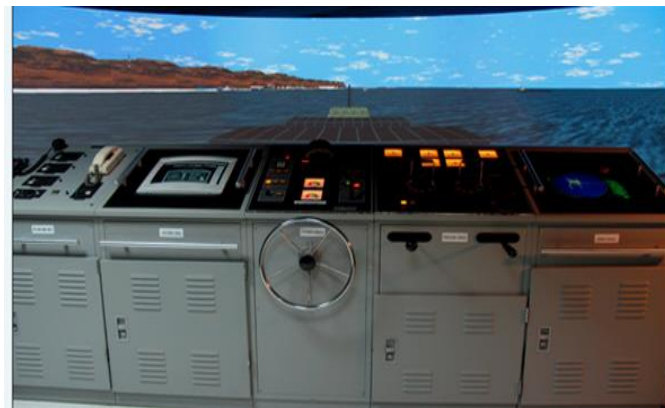
Hình 1.2 Hệ thống mô phỏng lái tàu thủy
