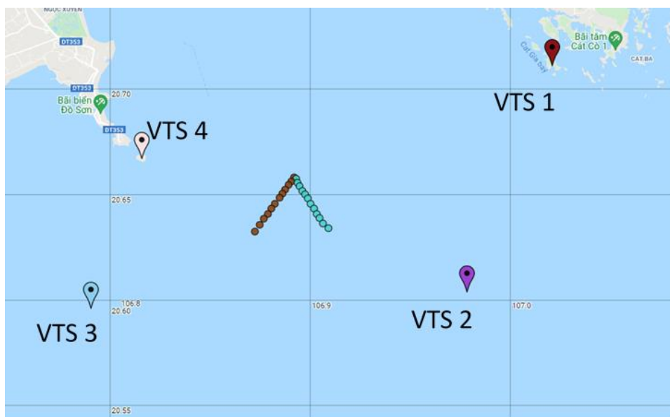
Hình 2.3. Bố trí tàu và các trạm VTS ảo trong bài tập thực nghiệm
