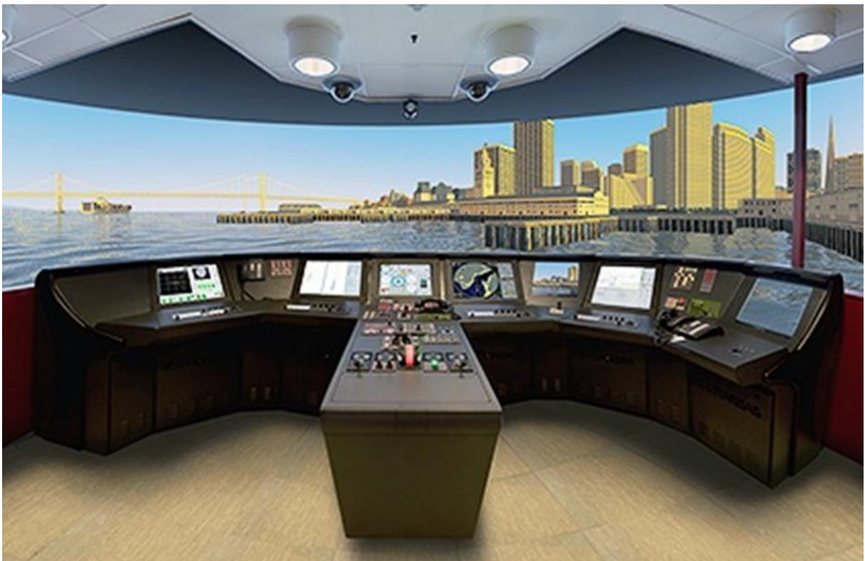
Hình 2.1. Hệ thống mô phỏng buồng lái tại Trường Đại học Hàng hải Việt Nam
