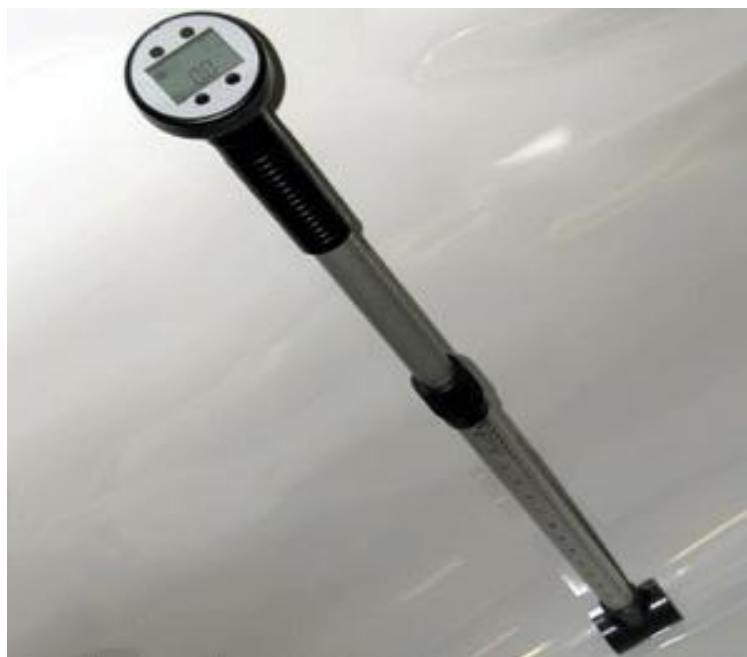
Hình 4.8. Thiết bị đo vận tốc trung bình tại mặt chuyển tiếp gắn với hệ thống
