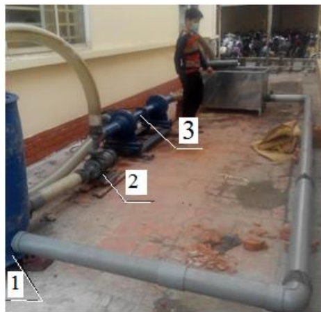
Hình 4.1. Sơ đồ lắp đặt hệ thống tách dầu trong phòng thí nghiệm 1- Két chứa hỗn hợp dầu nước; 2- Bơm ly tâm; 3- Thiết bị tách dầu.
