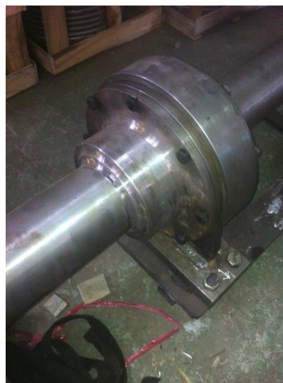
Hình PL5.4. Lắp ghép bích ống cố định và bích chặn vòng bi
