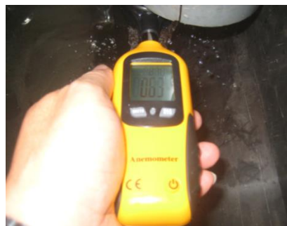
Hình 4.8. Thiết bị đo tốc độ dòng nước sau thiết bị tách dầu
