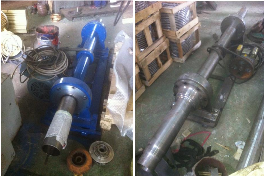
Hình PL5.1. Thiết bị tách dầu dạng ống quay ly tâm
