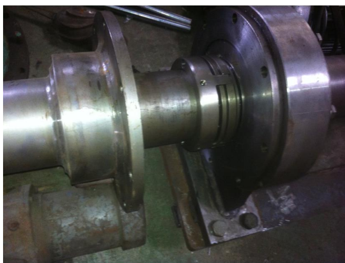
Hình PL5.4. Lắp ghép bích ống cố định và bích chặn vòng bi
