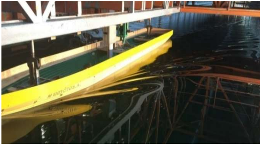
Hình 1.6. Thử mô hình DTMB tại bể thử của CTO, Ba Lan [14]
