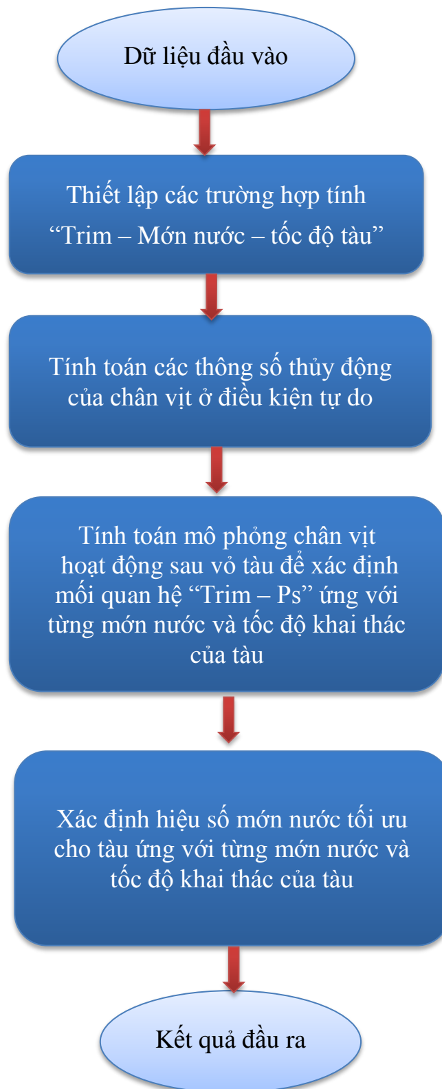
Hình 3.1. Sơ đồ khối mô hình bài toán tính toán ảnh hưởng của hiệu số mớn nước đến sự thay đổi công suất máy chính
