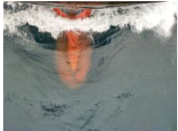
Hình 4.2. Hình dáng sóng tại mũi tàu do tàu tạo ra khi chạy ở các hiệu số mớn nước khác nhau với tốc độ 10.5 knots tại trạng thái toàn tải
