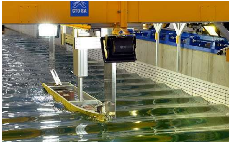
Hình 1.20. Phương pháp thử mô hình trong bể thử
