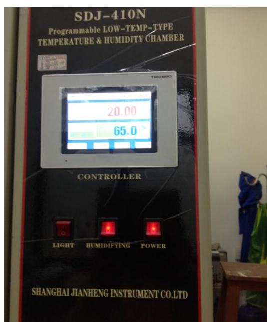
Hình 4.4. Lò tạo môi trường đo có nhiệt độ và độ ẩm chuẩn đạt T°C=20°C, RH=65%
