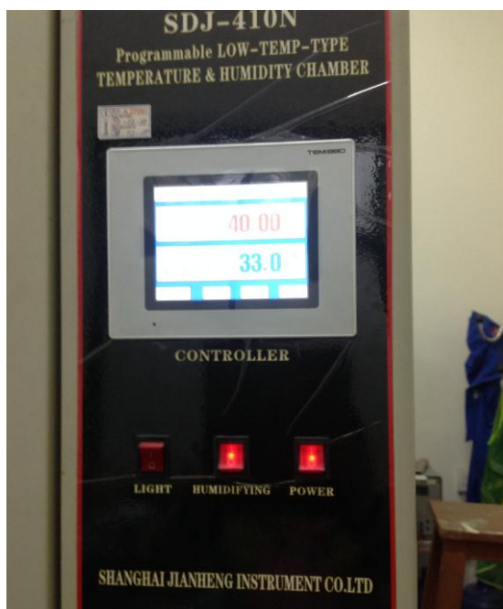
Hình 4.6. Lò tạo môi trường đo có nhiệt độ và độ ẩm đạt T°C=40°C, RH=33%
