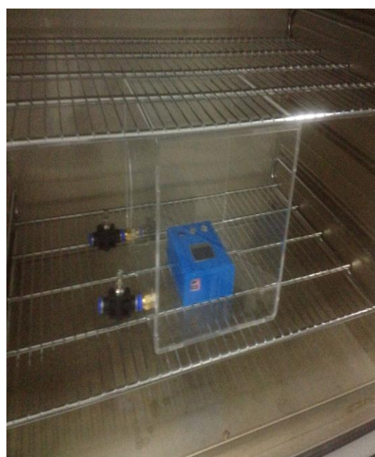
Hình 4.5. Thiết bị đặt trong khoang lò để tạo các giá trị độ ẩm và nhiệt độ khác nhau
