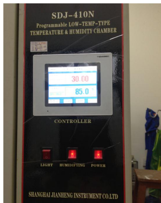
Hình 4.6. Lò tạo môi trường đo có nhiệt độ và độ ẩm đạt T°C=40°C, RH=33%
