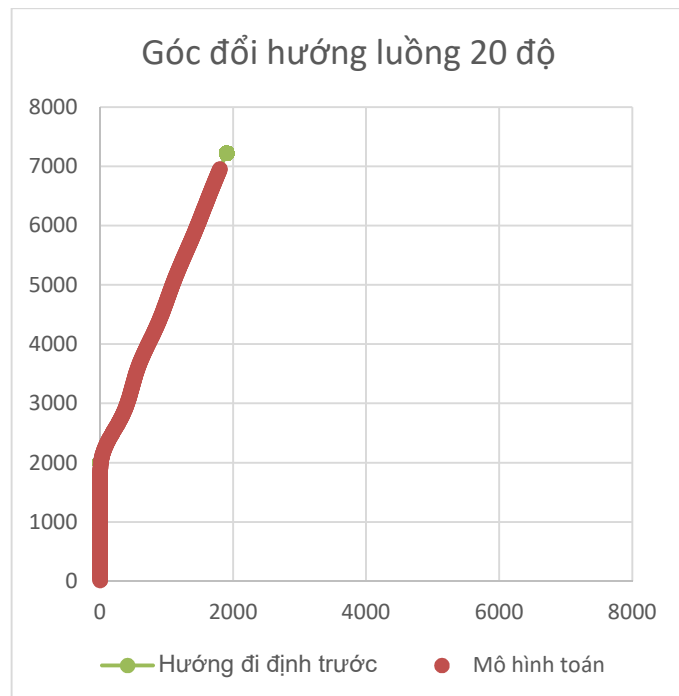
Hình 3.28 Mô phỏng chuyển động của tàu 28.000 DWT, khi thay đổi hướng 20°
