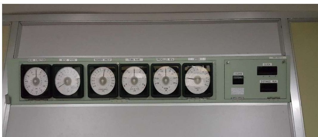
Hình 3.5. Hệ thống mô phỏng chỉ thị thông tin tàu
