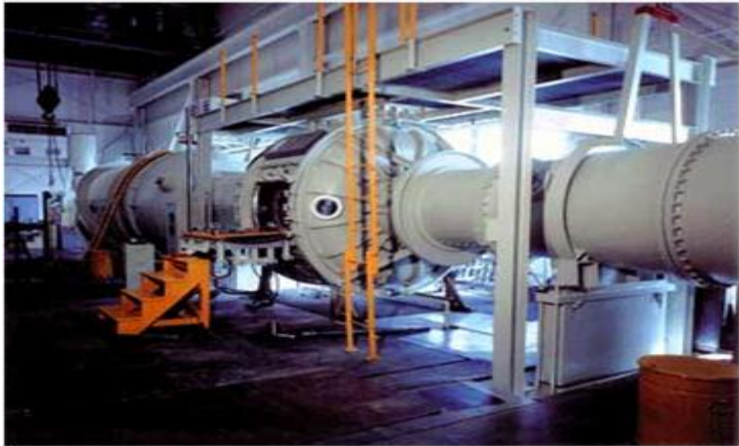
Hình 10. Hệ thống thí nghiệm xâm thực của hãng Carderock Division Sơ đồ nguyên lý cấu tạo của hệ thống mô tả theo hình 11.
