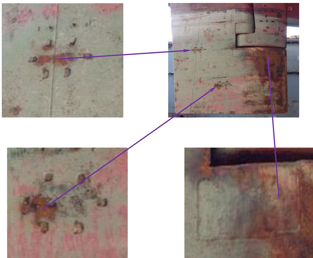
Hình 4.12. Phân tích thực địa hình ảnh ăn mòn bánh lái do xâm thực
