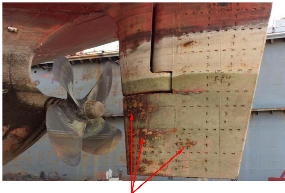
Một số hình ảnh bánh lái bị ăn mòn do xâm thực gây ra
