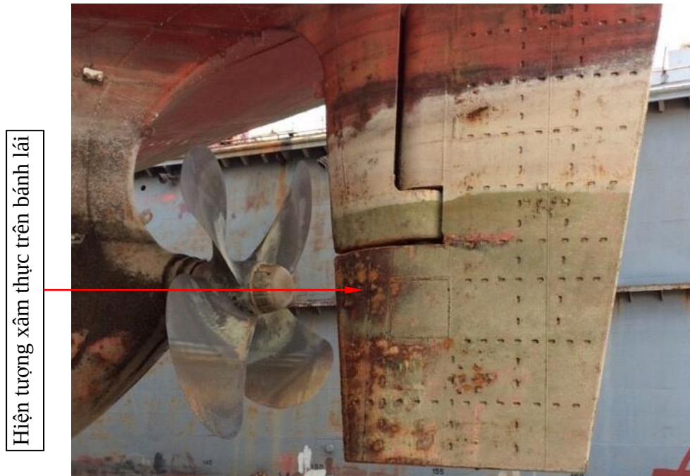
Hình 1.7. Xâm thực trên bánh lái tàu M/V TAN CANG FOUNDATION
