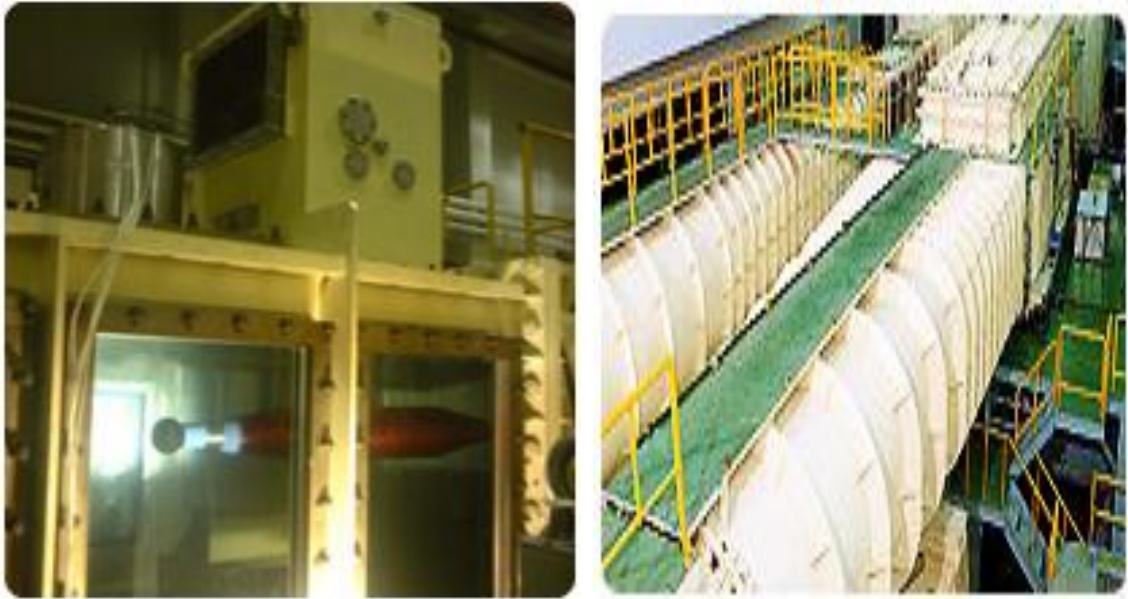
Hình 4. Hệ thống thí nghiệm nghiên cứu xâm thực của hãng Hyundai
