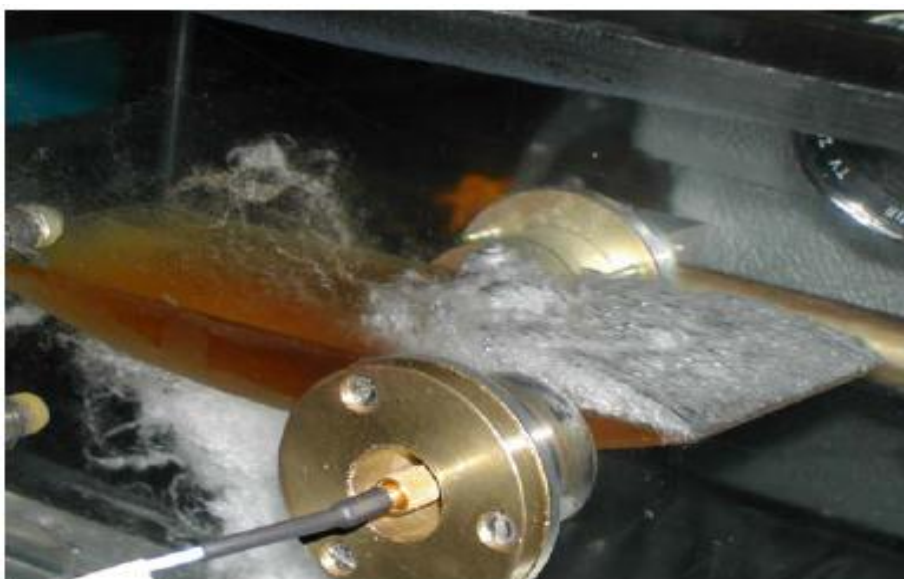
Hình 1.3. Hình ảnh xâm thực trên cánh
