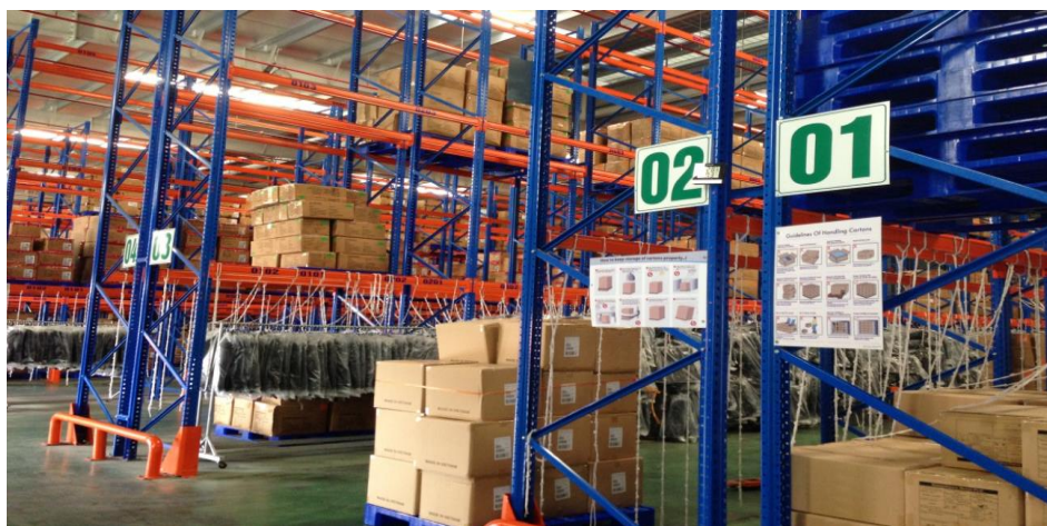
Hình 2.6 Hệ thống giá hàng (racking) trong kho xuất khẩu (Nguồn: Viconship)
