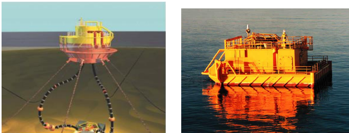
Hình 1.4. Phao dạng trụ tròn và khối hộp
