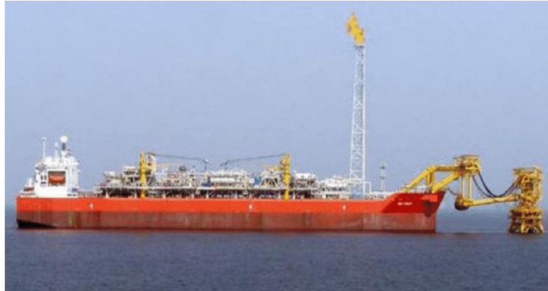
Hình 1.11. Dạng liên kết càn nối mềm với chân đế Jacket
