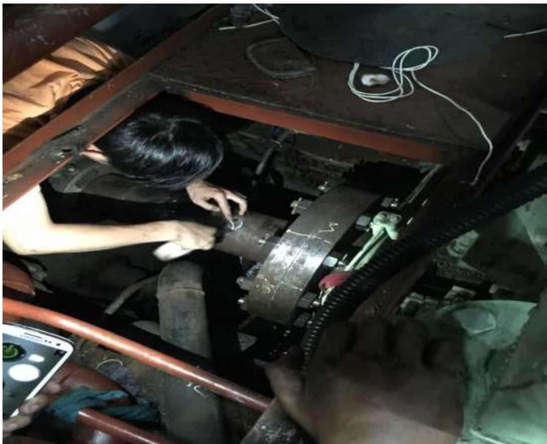
Hình PL3-6 Vệ sinh trục trung gian để dán tem biến dạng xoắn
