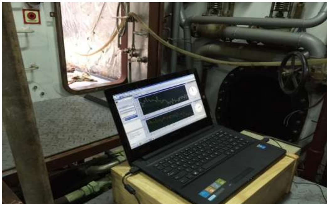
Hình PL3-8 Thực nghiệm đo tín hiệu biến dạng xoắn tại tàu
