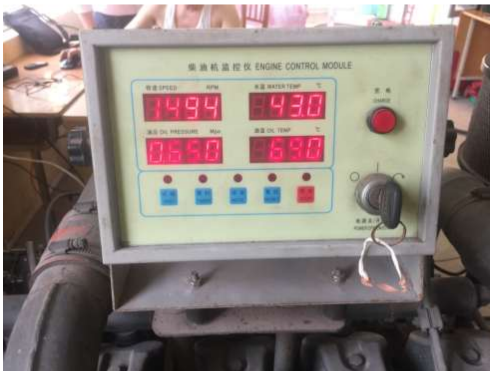
Hình PL3-4 Chế độ thử nghiệm tại vòng quay 1500 v/ph tại tải 100 A
