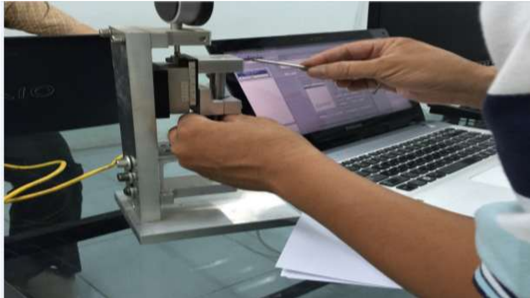
Hình PL3-1 Kiểm tra tính đáp ứng của tem dán biến dạng
