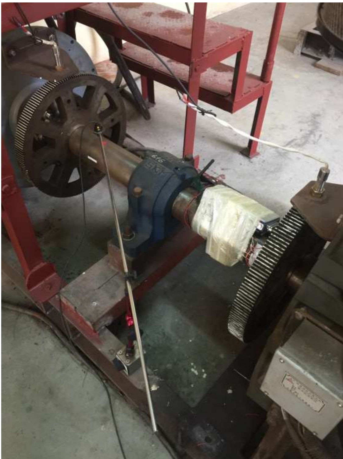
Hình PL3-3 Tổ hợp diesel lai máy phát có hoán cải đường trục tại PTN
