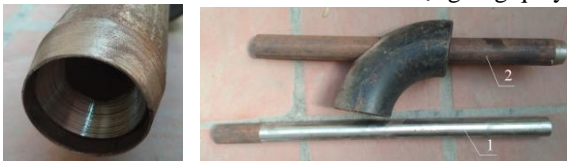
Hình 4.5. Ống thu dầu bản và ống gia cường 1- Ống thu dầu bản; 2- Ống gia cường.
