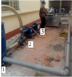
Hình 4.1. Sơ đồ lắp đặt hệ thống tách dầu trong phòng thí nghiệm 1- Kết chứa hỗn hợp dầu nước; 2- Bơm ly tâm; 3- Thiết bị tách dầu.
