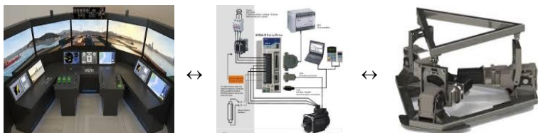
Hình 2.14 Cấu trúc mạng của hệ thống mô phỏng chuyển động tàu thủy
