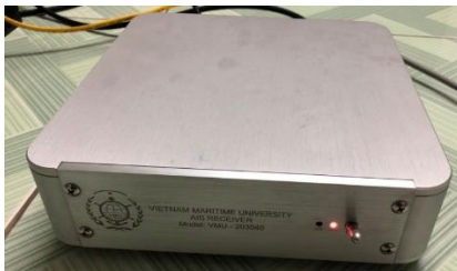
Hình 2.25. Bộ thu AIS mềm được thiết kế, chế tạo
