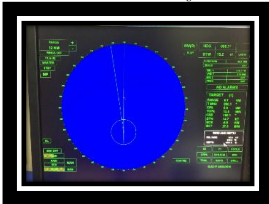
Hình 4.10 TCPA bắt đầu hành động tránh va và tại trung tâm mô phỏng buồng lái trong tình huống tàu MT đi đối hướng
