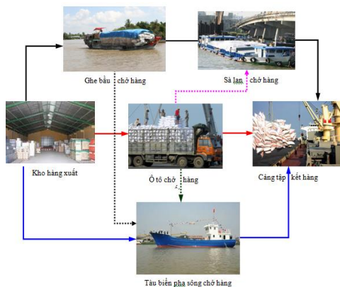
Hình 2.7. Mô hình vận tải đa phương thức 7 đường bộ - đường thủy nội địa - đường biển
