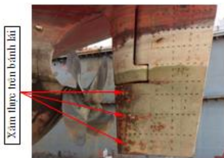
Hình 1.2. Xâm thực trên bánh lái tàu M/V TAN CANG FOUNDATION
